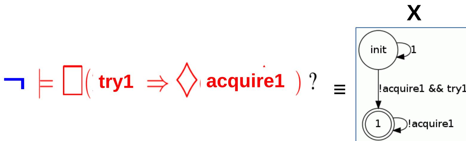
→ Le produit synchrone d'automate ne gardera que les chemins problématiques. Si l'automate résultant possède un cycle passant par un état acceptant, la propriété n'est pas vérifiée.
