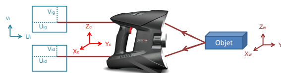
Figure 1: Exemple d'un système de reconstruction par stéréoscopie.
