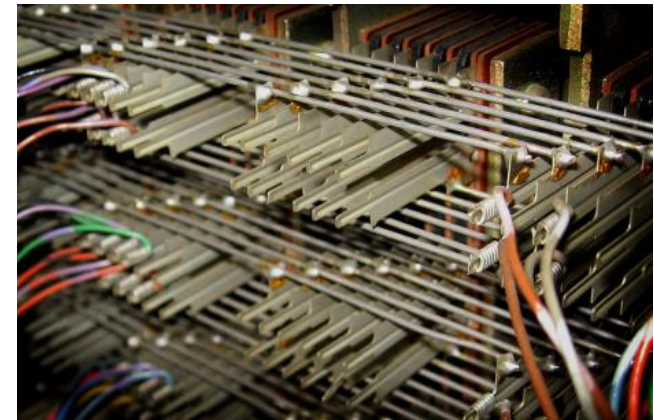
Commutateur téléphonique électro-mécanique (crossbar). D'environ 1920 à 1980
